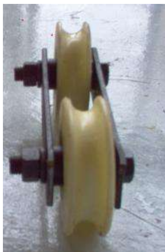
Figura 2. Polea de Nylamid
